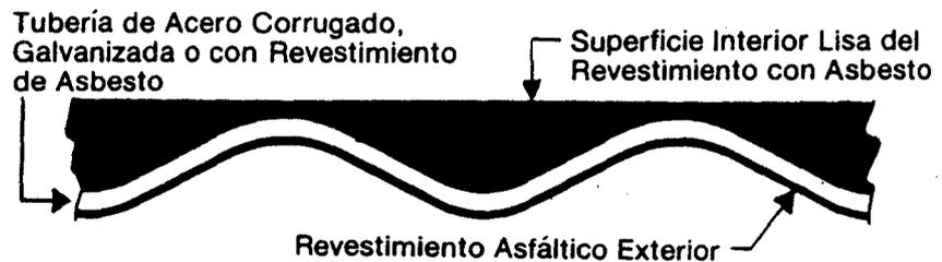
Fig. 8.2.1. Corte del revestimiento bituminoso centrifugado sobre todo el perímetro interior de la tubería de acero corrugado.
